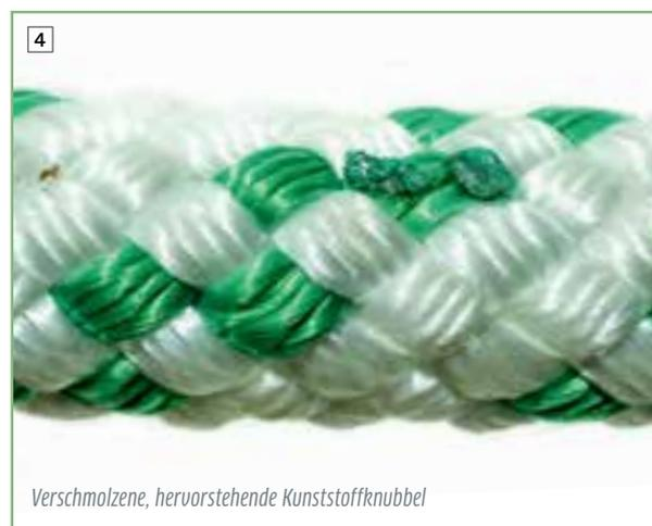
Kletterseile werden nicht isoliert genutzt, sondern sind immer Teil eines Systems. In der Einfach- oder Doppelseiltechnik wirken Klemmknoten (Abb. 5) oder mechanische Klemmgeräte (Abb. 6) auf das Seil ein. An verschmolzenen Stellen entstehen Reibungspunkte, die nicht nur das Seil lokal beschädigen, sondern eine Angriffsfläche für andere Komponenten bieten können.
