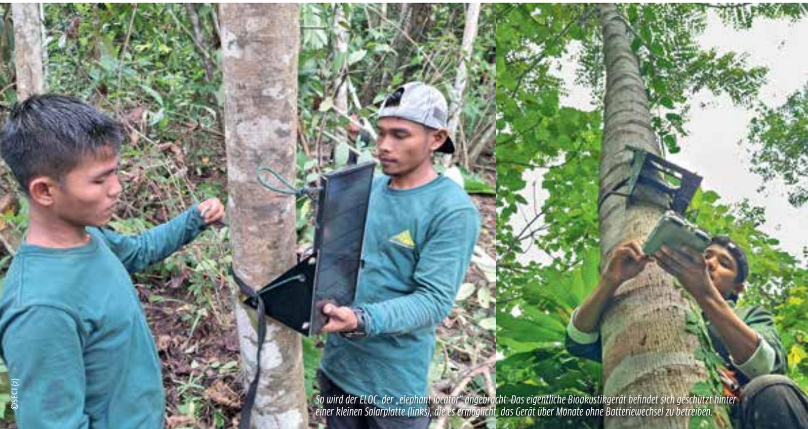
So wird der ELOC, der „elephant locator“ angebracht: Das eigentliche Bioakustikgerät befindet sich geschützt hinter einer kleinen Solarplatte (links), die es ermöglicht, das Gerät über Monate ohne Batteriewechsel zu betreiben.
