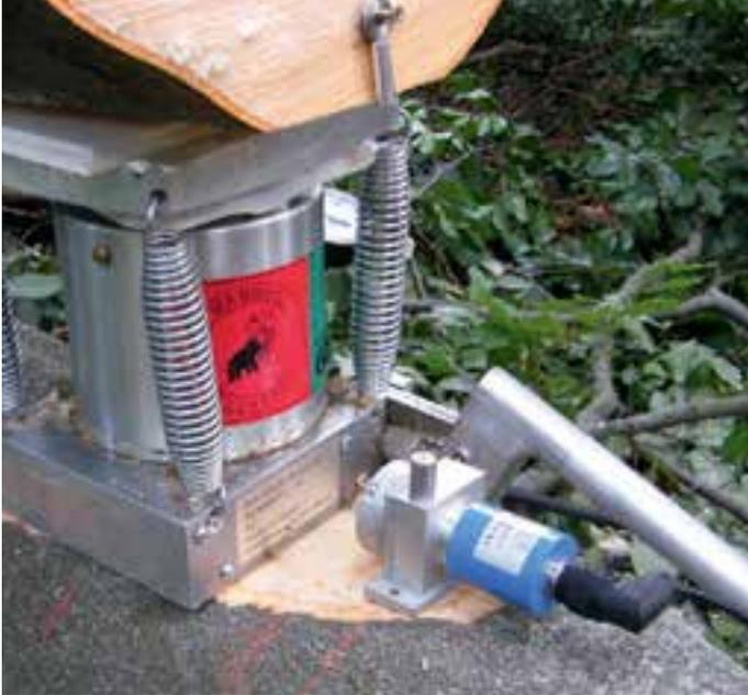
Abbildung 2: Nahaufnahme des hydraulischen Fällhebers. Ebenfalls ist die Längenmessung gut zu sehen. Um ein Abrutschen zu verhindern, wurde die Vergabelung mit der Motorsäge angepasst.
