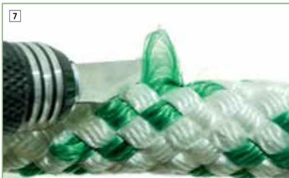
*Tipp: Mit einem scharfen Cuttermesser die losen Fasern vorsichtig und ohne starke Zugbelastung knapp über dem Seilmantel abtrennen.*
