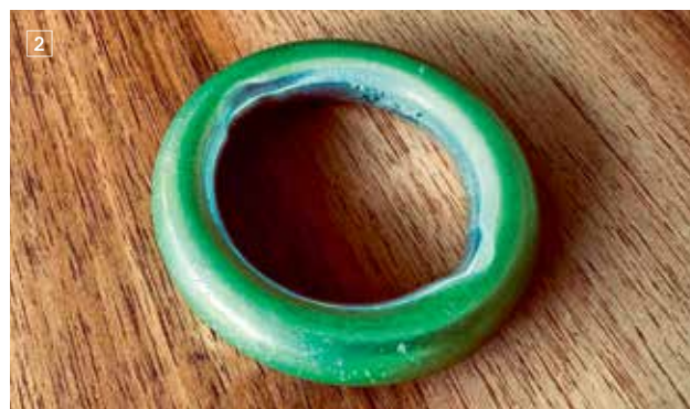
2 Wenn eine leichte Unebenheit auf der Oberfläche dazu führt, dass ein Ring sich immer zur gleichen Stelle hin orientiert, entsteht eine Kerbe. Sobald diese anfängt sich zu bilden, kommt darin entweder die Seilbrücke oder der Karabiner des Positionierungssystems zu liegen. So entstehen schließlich zwei gegenüberliegende Kerben.
