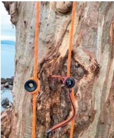
Jetzt wird der SliderSpool in einen Mastwurf eingebunden. Der SliderSpool ist noch vom TwinLine getrennt. Deshalb ist der Einbau einfacher und schneller.
