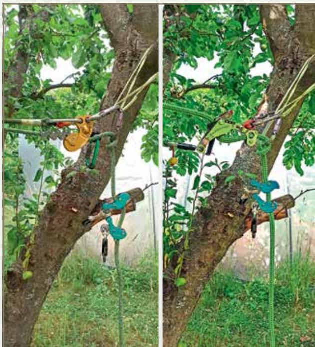
**Bild 2/2a** Mit etwas Schlauffeil verbunden ist auch, die freie Aufnahme im ZigZag mit der Umlenkung zu verbinden. Loses Seil mittels Halbmastwurf (HMS) in den Umlenkarabiner, das Einfachseilgerät aufsetzen. Analog dazu: SpiderJack blockieren, Seil mit HMS in die Umlenkung, Einfachseilgerät aufsetzen und weiter!
