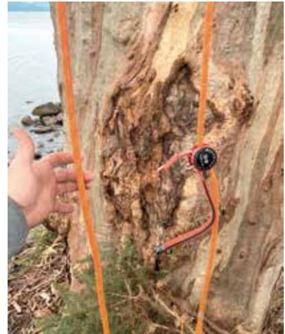
Es ist egal, auf welcher Seite der RopeGuide TwinLine installiert wird. Meist ist es einfacher, den Seilstrang zu nehmen, der über die Gabel gezogen wurde. Der TwinLine hat für dieses Setup keine Rolle.
