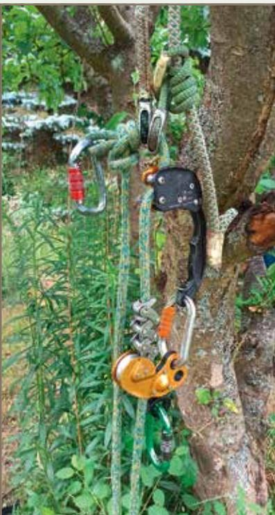
**Bild 6** Nach dem Mittag wieder aufsteigen: Seilauge aushängen und so viele Meter darüber, wie ich aufsteigen muss, einen Schmetterlingsknoten setzen. Gegen den Kambiumschoner ziehen und am anderen Ende aufsteigen.
