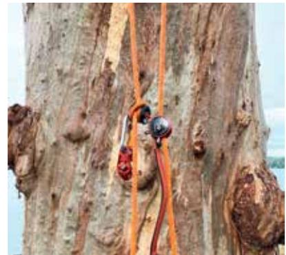
Der Ausbau zum Schluss erfolgt wie gewohnt mit der Abziehkirsche am Seilauge des umlaufenden Kletterseils.
