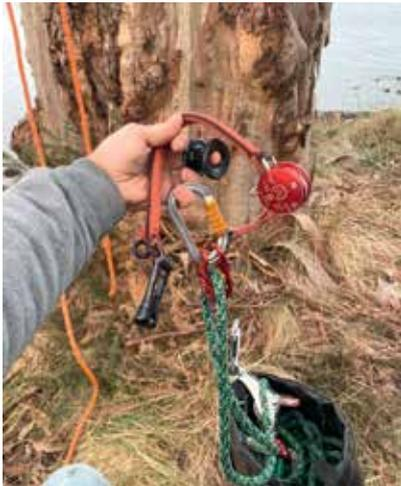
Für das Setup wird folgende Ausrüstung benötigt: ART RopeGuide TwinLine inklusive Slider Spool, ART Trapeze Schäkel, Karabiner, Aufstiegsseil, Kletterseil.
