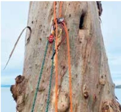
Jetzt kann das ganze System in den Baum gezogen werden. Falls man auf der Mastwurfseite klettern möchte, muss der TwinLine nicht vollständig bis zum Ankerpunkt gezogen werden. Wenn für den Aufstieg die Seite gewählt wird, die durch den TwinLine läuft, muss das System jedoch komplett bis zur Gabel gezogen werden. Am Ankerpunkt sind nun drei Seile installiert: zwei stehende Seile und ein umlaufendes Seil.
