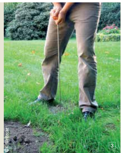
Untersuchung der Bodenverdichtung mithilfe eines Sondierstabes
