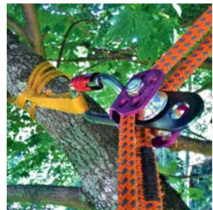
Abb. 3: Bandschlinge mit Karabiner und doppelter Umlenkrolle
